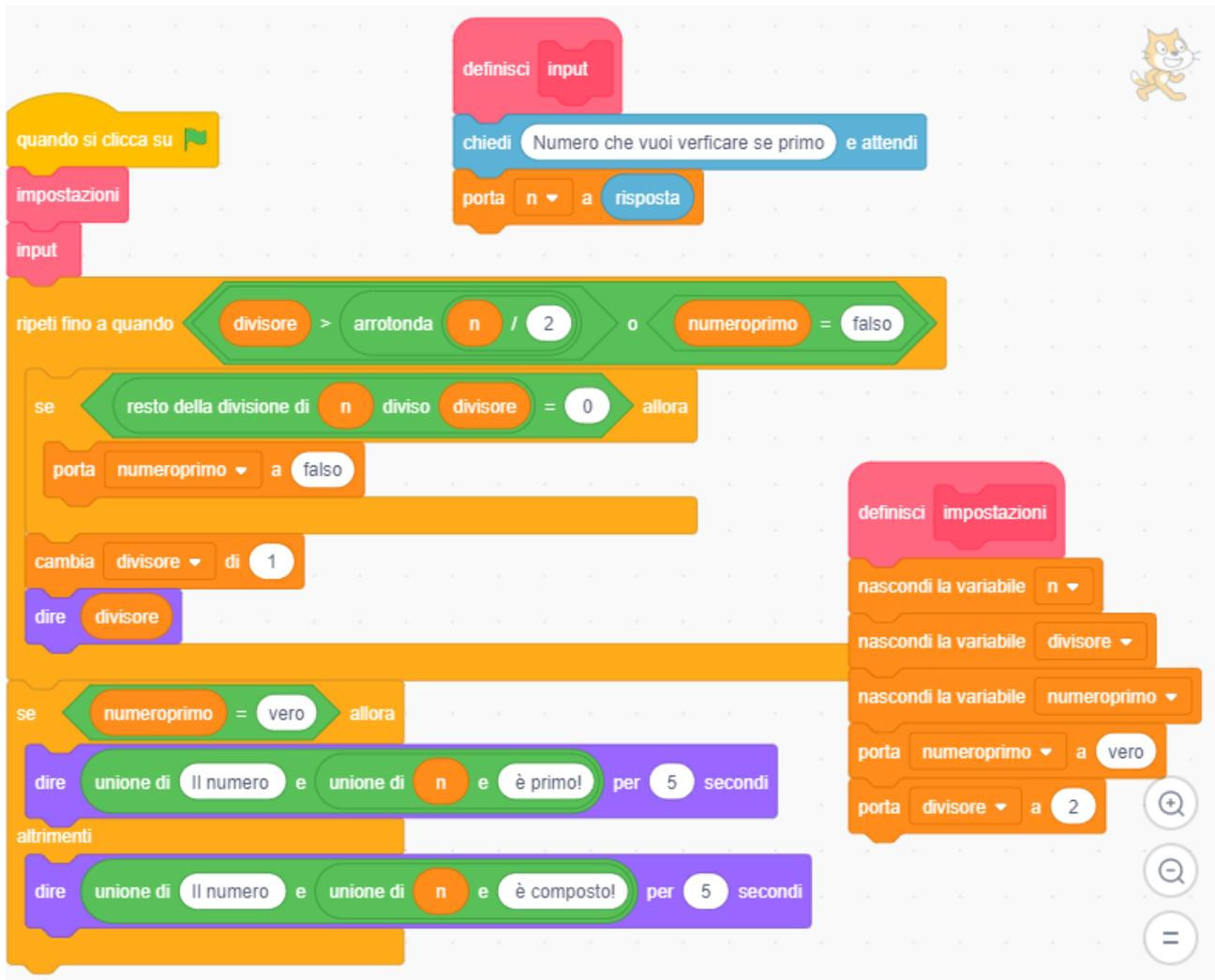
Nella prima si usano due blocchi personalizzati, uno per le impostazioni e uno per la acquisizione (input) del numero di cui verificare la primalità.
